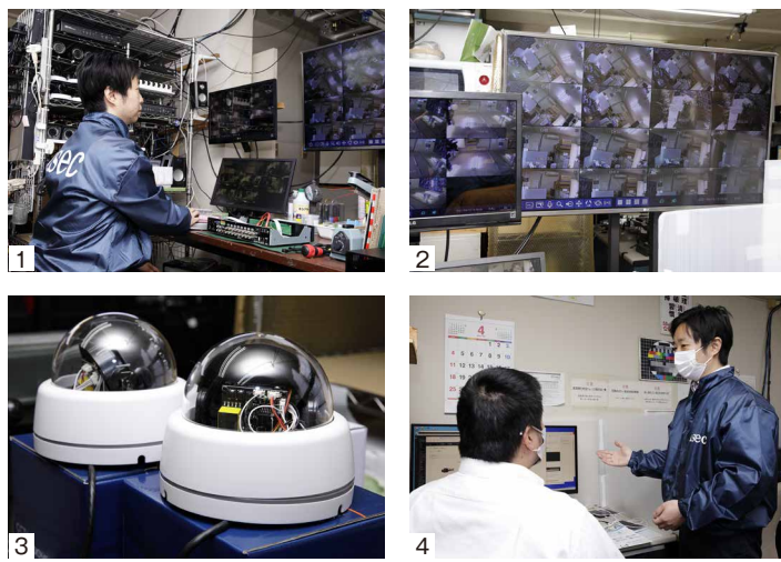
① 納品された製品に問題がないか、個体をひとつひとつ検品していく。かつて大企業に勤めていた時は完全に分業化していたが、ここでは経営者としてだけでなく、こうした技術者としての業務も日々こなしている ② 一画面に複数のカメラ画像をモニタリングできるグラフィックインターフェース、クライアントソフトを使えば、カメラを遠隔操作できる ③ 薄暗い場所でも被写体を検出するアイゼックの主力商品・ドーム式赤外線カメラ。高解像度イメージセンサーを搭載し、高精細な画像を記録する ④ 将来的には「(既存の)仕事に人を合わせるのではなく、そこに合った仕事を作るような会社になりたい」と中村氏は抱負を述べた
